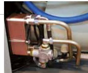
Die Baugruppe "Wärmerückgewinnung" ist perfekt in den Ölkühlkreis integriert. Die Vorrichtung führt die Temperaturkontrolle des Öls unabhängig durch und ist somit vor Störungen geschützt, wie z.B. vor Reduzierung der Wasserdurchflussmenge oder vor Überhitzung.
