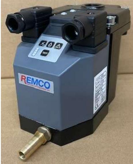
Der Remco 100 entfernt Kondensat aus Druckluftsystemen bis zu 100 m<sup>3</sup>/min. ohne Druckluftverlust. Das kompakte, robuste Industriegehäuse, das direktwirkende 2/2-Wege-Ventil mit großer Öffnung, der Alarm N/C oder N/O und der integrierte Schmutzfänger machen den REMCO 100 zu einer äußerst zuverlässigen Entwässerungslösung mit digitaler Sichtöffnung.
